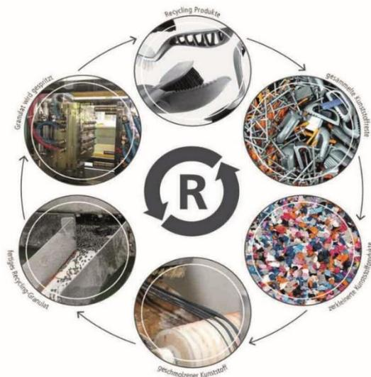
Das Diagramm zeigt den Kreislauf des Kunststoffrecyclings. Es beginnt mit 'Recycling Produkte', die zu 'geschmolzener Kunststoff' verarbeitet werden. Dieser wird in 'zerkleinertes Kunststoffprodukt' zerkleinert, dann in 'granuliertes Kunststoffprodukt' granuliert. Das 'Granulat nach Sortier' wird in 'Inhalt Recycling-Granulat' überführt, welches wiederum in 'Recycling Produkte' zurückgeführt wird. Ein zentrales Element ist das Recycling-Symbol 'R' in einem Kreis.
